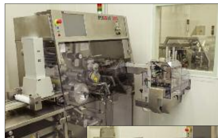
Блистерная машина производителностью до 5000 блистеров в час. С нее лекарственные препараты поступают в соседнее помещение на вторичную и окончательную упаковку лекарственных препаратов в транспортные гофрокороба.
