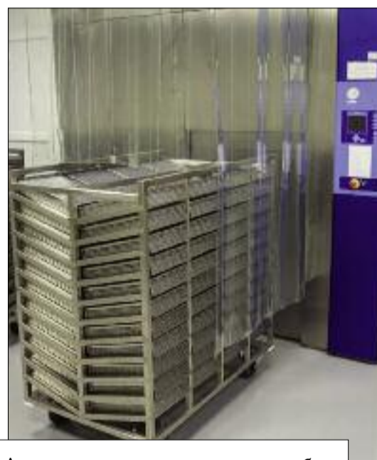
Автоклавирование – термическая обработка флаконов с полупродуктом в автоклаве (вторая вирусная инактивация).
